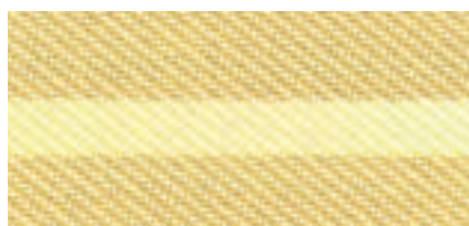
Soudure d'une toile en fibre de verre
