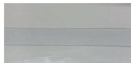
Soudure d'une toile Cristal Plus
