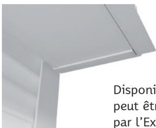
Disponible en 3 dimensions (150, 165 et 180 mm), ce coffre peut être intégré dans un système d'Isolation Thermique par l'Extérieur (ITE) ou d'un Maison à Ossature Bois (MOB). La sous face qui ne présente aucune vis apparente, est démontable sans outils. Elle donne une accessibilité rapide et facile au volet roulant.
