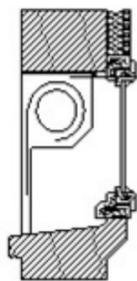
La VERTICALE PLUS se pose uniquement en enroulement intérieur
